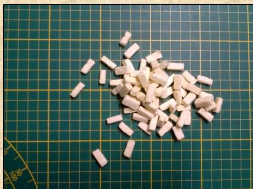
Avec la pyroscie, je découpe dans la plaque d'XPS des bandelettes de 5 mm de section. Ces bandelettes sont ensuite réduites à des briques d'environ 12 mm de longueur. Il n'est pas nécessaire d'être très précis. Les différentes tailles permettent de donner un certain relief aux murs. Une fois ces briques réalisées, elles sont placées dans un pot avec quelques cailloux et secouées pendant environ 1 minute afin de leur donner une texture usagée. Faites beaucoup de briques.
